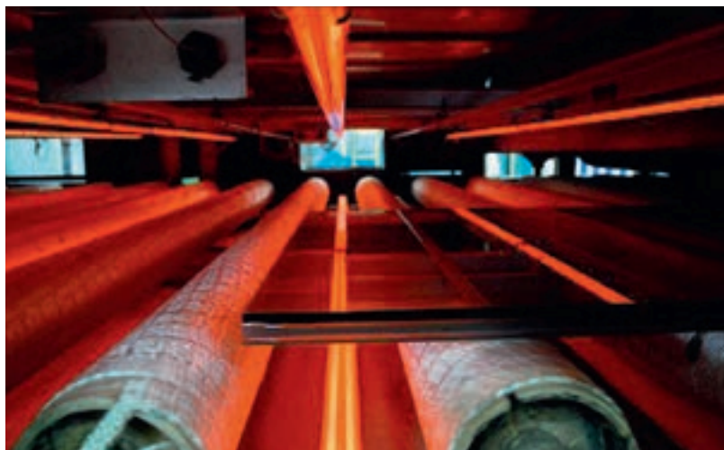
Abkühlungsprozess des Floatglases während der Produktion.
